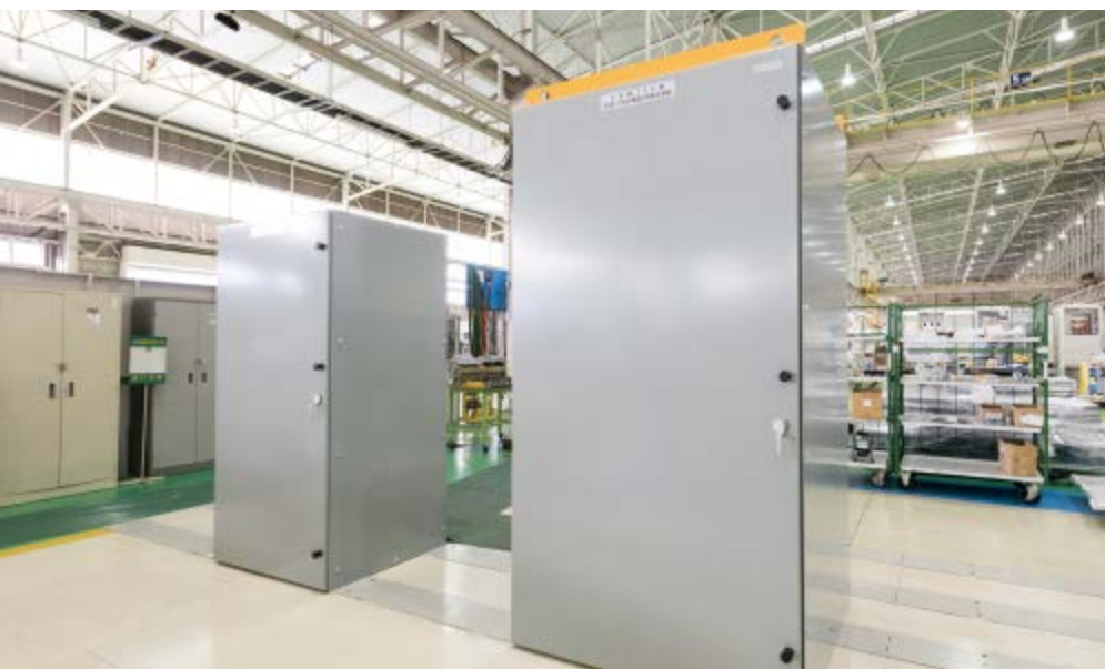
配電盤や変圧器などが組み込まれた筐体
