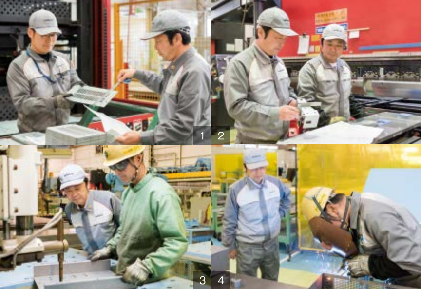
1.切断した鋼板の寸法を確認 2.曲げ加工 3.接合 4.最も神経を使う溶接工程
