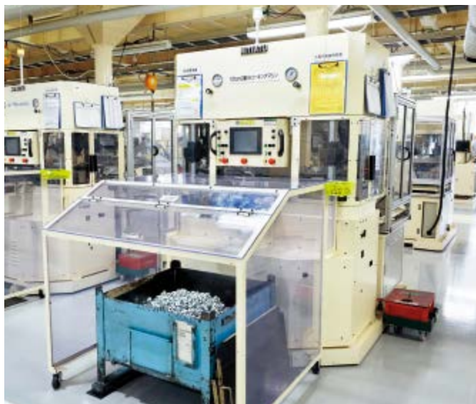
コークングマシン。10tのプレスをかけて戻り止め機能を付加する
