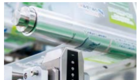
高速印字を担う印字ヘッド
