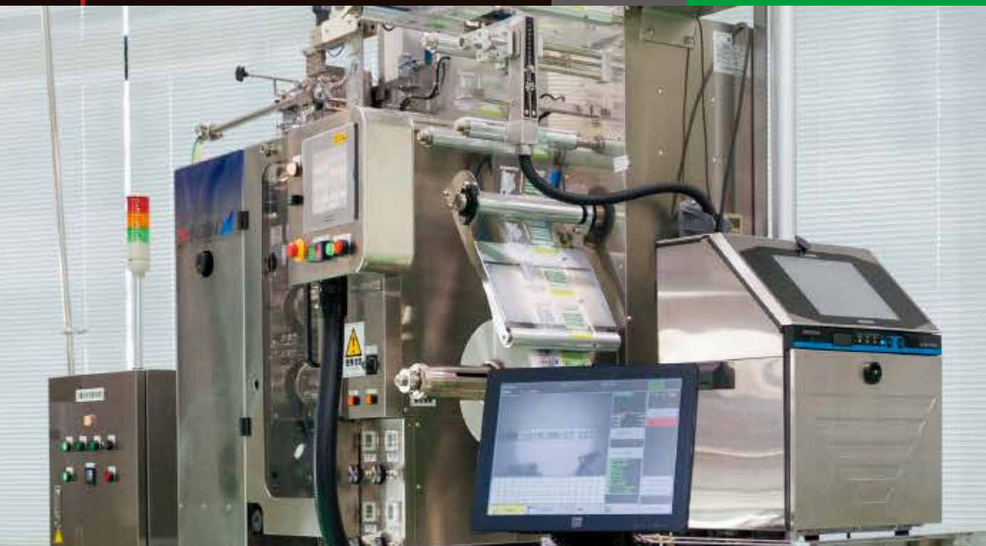
DANGAN ASTRON MARKⅡに搭載された日立産業用インクジェットプリンタ「Gravis UXシリーズ」
