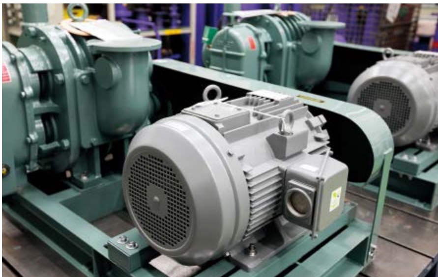
ルーツブロワに搭載された日立製モータ
