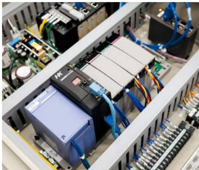
ルーツ式真空ポンプのIoT化を実現する日立製IoT対応産業用コントローラ「HXシリーズ」
