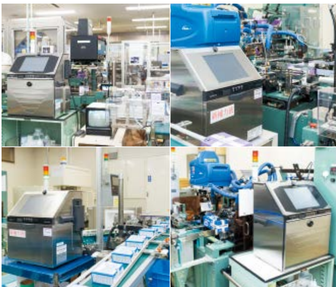
パッケージ印字ラインで稼働する日立産業用インクジェットプリンタ
