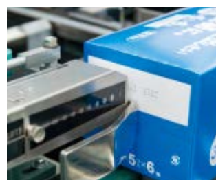
インクジェットプリンタの印字ヘッド
