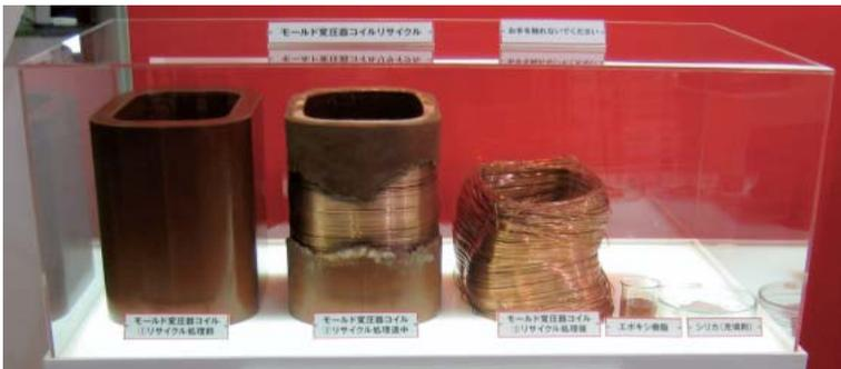
モールドコイルのリサイクル過程 左から処理前、処理途中、処理後、エポキシ樹脂シリカ(充填剤)
