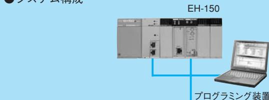
光CPUリンク(1Mビット/s、局間1km、総延長15km、64台、1,024ワード)
