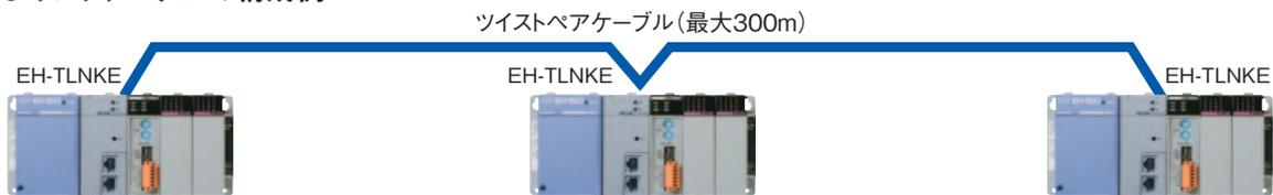
互換モード、標準モードが使用できます。接続台数は互換モード時8台、標準モード時32台までとなります。
