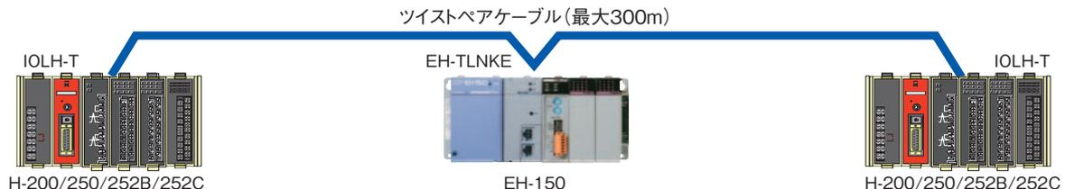
互換モード(低速モード(HS:OFF))の設定で混在使用できます。接続台数は8台までとなります。
