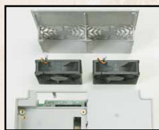
簡易着脱式冷却ファン
