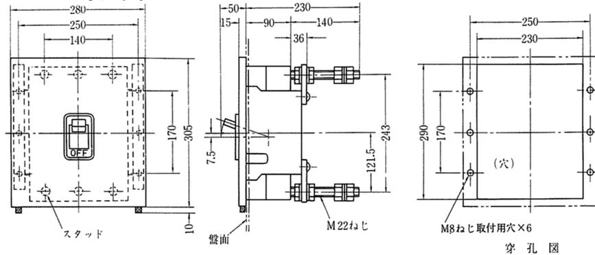
外部操作装置寸法図 (フレーム6, 又は6S)
