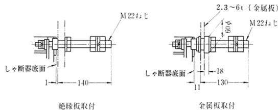
外形寸法図 (単位:mm)
