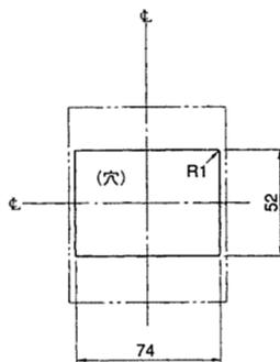
寸法は遮断器の窓枠に対して片側1mmのすき間をもたせた場合です。
