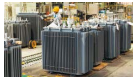
中条事業所の主力製品である変圧器の生産ライン ここでも省エネ取り組みが進んでいる
