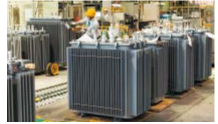
中条事業所の主力製品である変圧器の生産ライン ここでも省エネ取り組みが進んでいる
