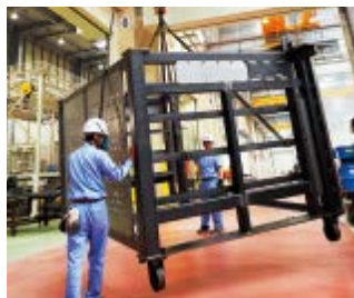
溶接後の製品をホイストでつり上げて移動
