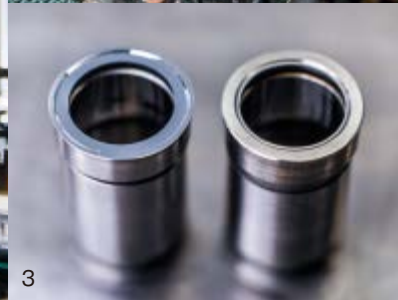
1.バラエティに富んだ工具。磨き方で使い分ける。2.凹凸部の研磨に手づくりの工具を使う。3.磨いた後(左)、磨く前(右)。4.仕上げの精度は検査室で厳しく確認する。
