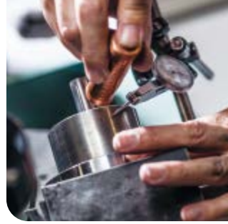
高い精度の研磨の前に、回転の中心を正確に計る。精密な製品を仕上げるためには欠かせないプロセス。
