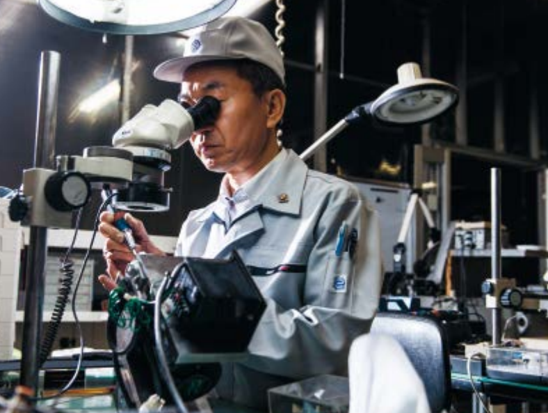
金型製品の部品は、顕微鏡を覗きながら丁寧に磨いていく。気が抜けない作業だ。
