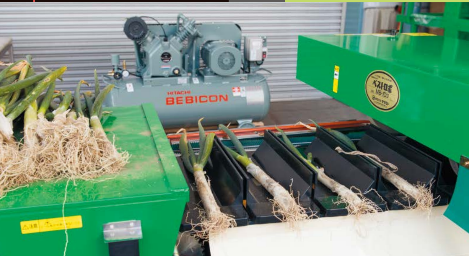
長ネギ用半自動根・葉切り皮むき機と日立産機システム製の小型コンプレッサー「ベビコン」
