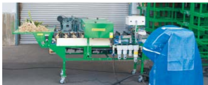
根・葉切り、皮むきという2つの作業を1台に集約した「ベストロボ」
