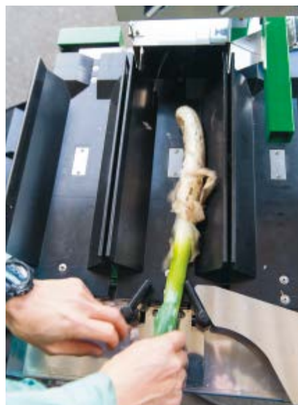
エアの力で皮むきも簡単に ※撮影のためカバーを外している
