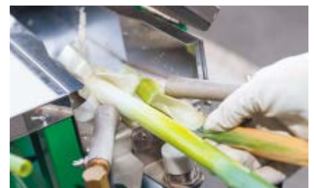
回転するチューブから出てくるエアできれいに早くむける
