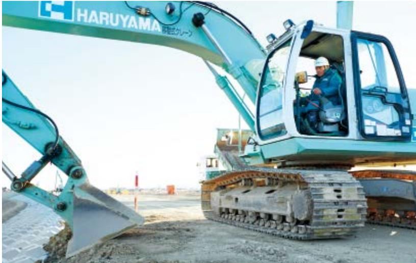
オペレーターはモニターで3次元設計データを背景にリアルタイムでバケットの刃先位置を確認しながら作業ができる
