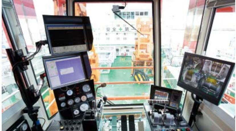
クレーンのオペレーター室に搭載された、操船室と同一のグラフしゅんせつ管理システム
