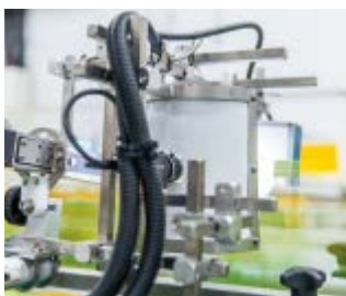
印字の正確さをチェックする印字検査機
