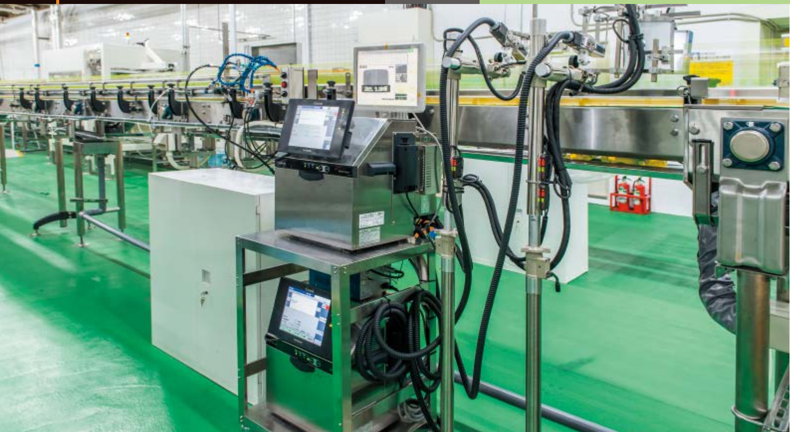
PET容器のキャップ2カ所に2台のインクジェットプリンタで印字
