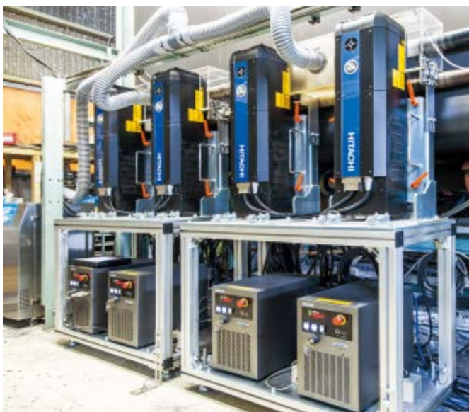
2m幅のカーペットに4台のレーザーマーカで印字する
