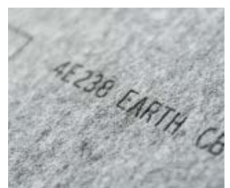
カーペットの裏面が不織布の場合の印字品質
