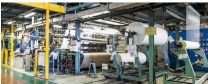
タイルカーペットの貼り合わせ工程
