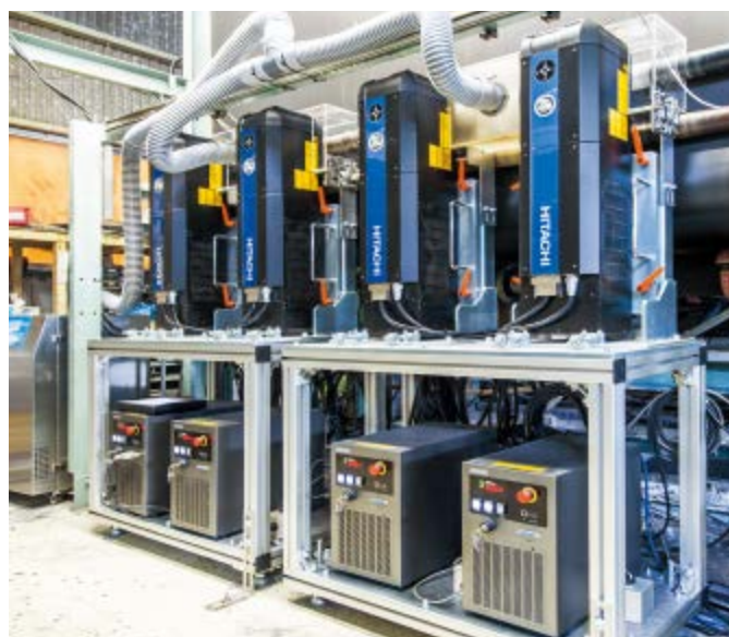
2m幅のカーペットに4台のレーザマーカで印字する
