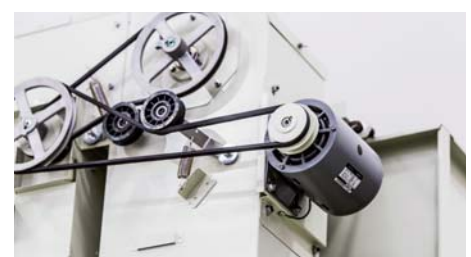
遠赤外線乾燥機に搭載された日立産機モーター
