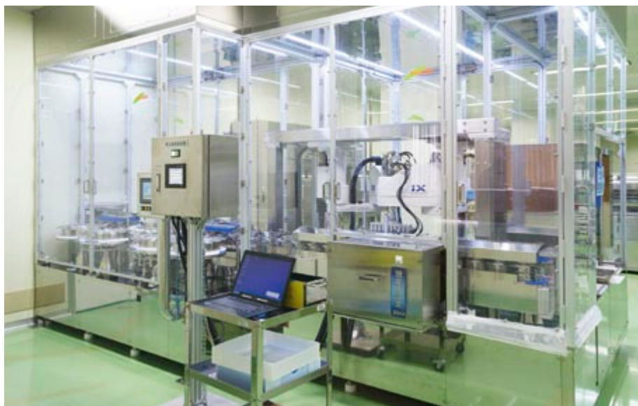
化粧品を充填する容器の底に見えないインクで印字されたデータを、瞬時に読み取る
