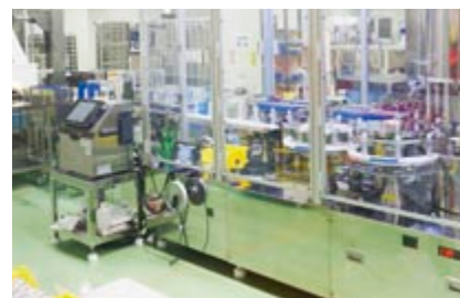
非接触型のインクジェットプリンタによる高速印字
