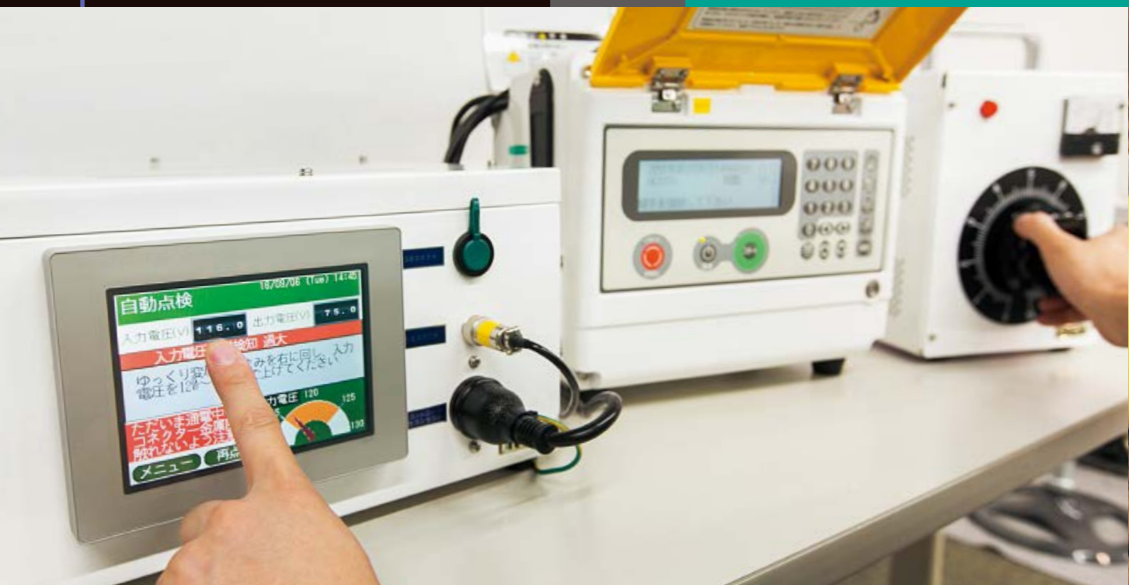
ガス用EF(エレクトロフュージョン)コントローラチェッカー
