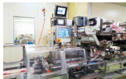
パッケージング後、金属探知機で異物などを厳しくチェック
