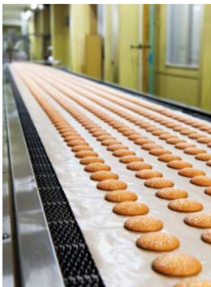
1時間に「ナボナ」7,000個分の皮を焼く製造ライン
