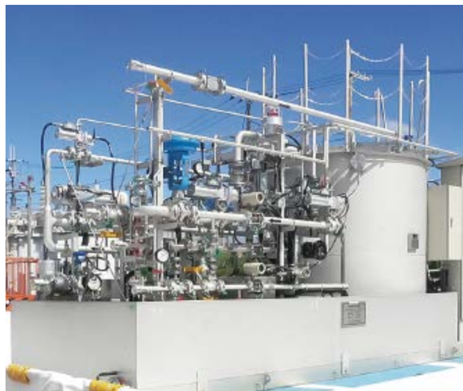
PCB現地洗浄処理装置で、お客さまの敷地内で解体せず安全な処理が可能
